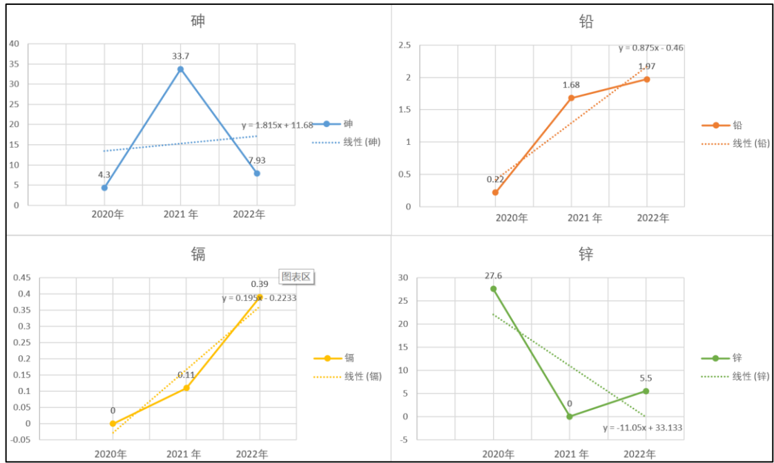
图 8-5 二车间沉降池西侧监测井各检出因子变化趋势图
